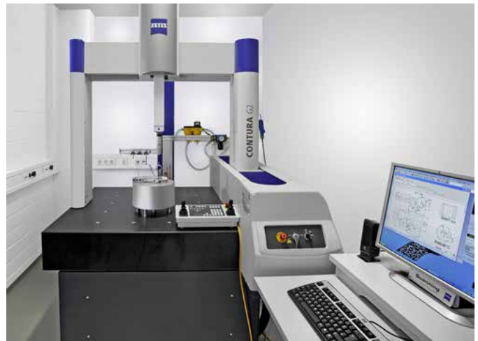
Zeiss Contura G2 Koordinatenmessmaschine mit 5 Achsen
